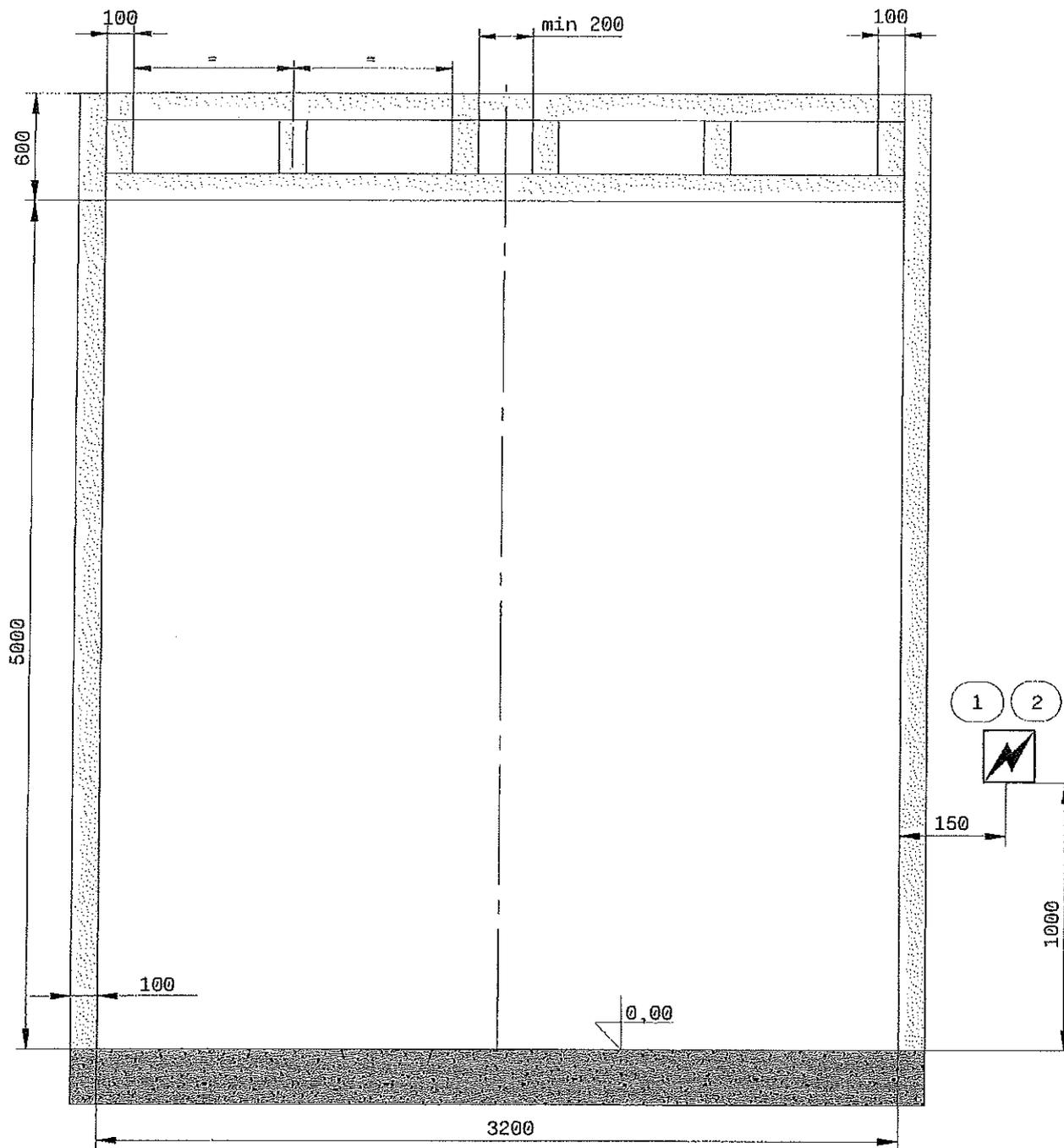
La struttura è realizzata da profili chiusi 100x100x4 o più grandi, dovrebbe formare un piano allineato all'interno del locale. Lo spazio necessario per montaggio il portone deve essere libero di tutti i tipi di tubi, fili, ecc.
